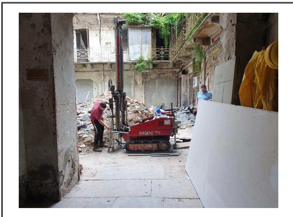
Foto 1: Posizionamento prova penetrometrica dinamica DPSH 1.
