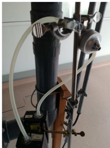
Figura 3-Campionamento di polveri inalabili su filtro
