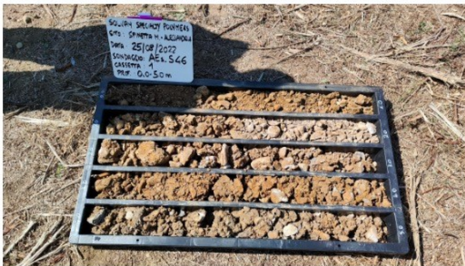
Foto 3. Campionamento terreni insaturi mediante sondaggi ambientali
