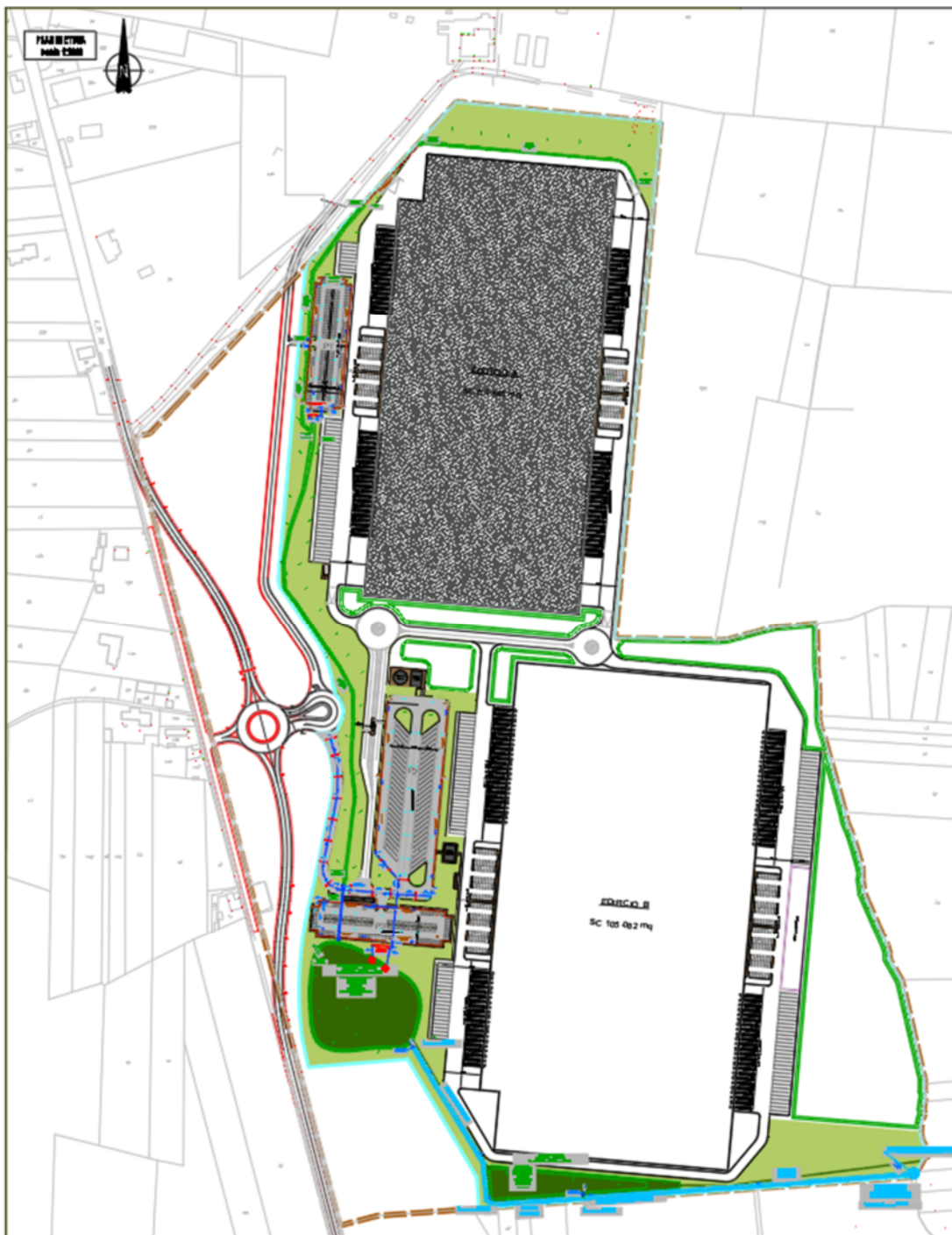
Figura: Planimetria rete smaltimento acque meteoriche
